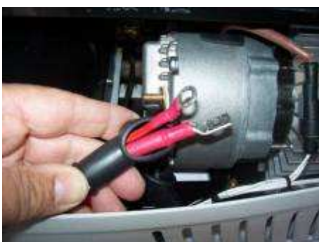
1. Dévisser les deux écrous de la borne + du moteur. Faire passer le câble rouge de raccordement à l'intérieur du capuchon
