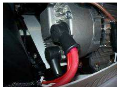
3. Remettre le capuchon en place. Répéter les opérations 1 et 2 sur la borne - du moteur avec les fils et câble de masse (noirs)
