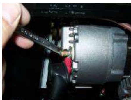
2. Revisser les écrous sur les deux cosses rondes des fils et câbles positifs (rouges) et la rondelle éventail
