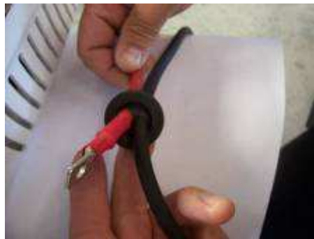
2. Passer les deux câbles dans le passe-fil percé de deux trous
